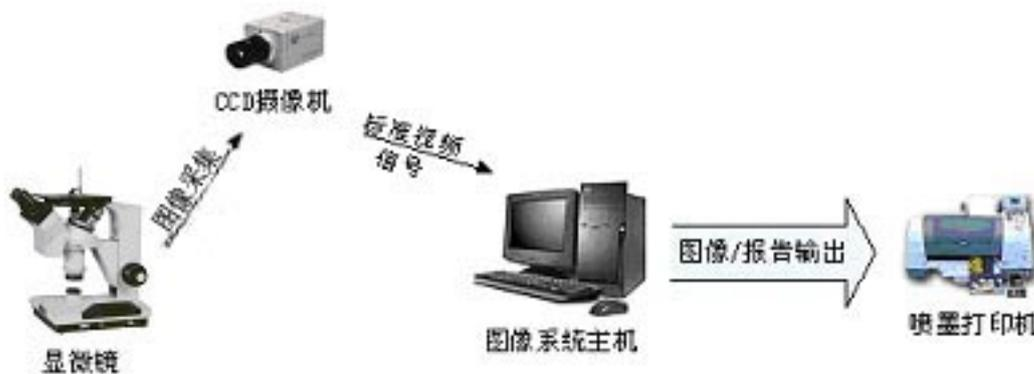
图 13 MIAPS 图像分析系统硬件连接示意图
